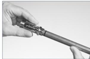
Schieben Sie das Rohr vorsichtig in den Kugelhahn, bis die Markierung der Einstecktiefe erreicht ist. Dabei wird das Rohr gedreht und senkrecht eingesetzt. Die Kennzeichnung der Einstecktiefe muss sichtbar bleiben. Grobes oder unvorsichtiges Einsetzen des Rohrs in den Kugelhahn kann den O-Ring beschädigen und ist daher zu vermeiden. Wenn die Montage, z. B. aufgrund von engen Toleranzen schwierig ist, kann etwas Wasser oder Seife verwendet werden.
