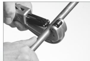
Nach dem Ausmaß können die Rohre mithilfe eines Rohrschneiders, einer fein gezahnten Handsäge oder einer für das Rohrmaterial geeigneten Elektrosäge gekürzt werden.
