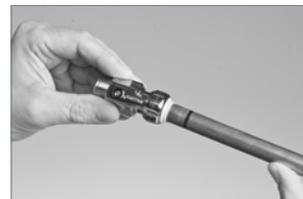
Bei der Montage verchromter Kupferrohre sind vorgängig aufzurauchen, um einen sicheren Halt des Steckfittings zu gewährleisten.
