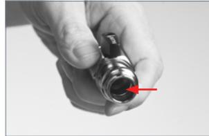
Vor der Montage ist der Kugelhahn zu überprüfen, um sicherzustellen, dass die O-Ringe vorhanden und korrekt platziert sind. Rohr, Kugelhahn und O-Ring sind auf Fremdkörper zu überprüfen (z. B. Schmutz, Grate). Eventuelle Fremdkörper sind zu entfernen.
