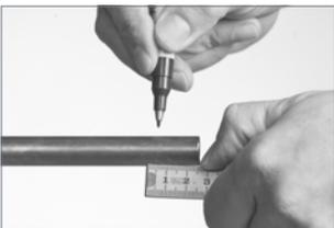
Um eine gute und sichere Verbindung zu erreichen, ist die erforderliche Einstecktiefe (siehe Tabelle 2) auf dem Rohr zu markieren. Ein zuverlässiges Verpressen mit den entsprechenden Zugfestigkeiten kann nur erreicht werden, wenn
