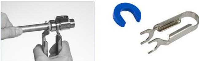
Verwenden Sie das Demontagewerkzeug, um den Steckfiting zu lösen. Die Gabelseite wird um das Rohr gelegt, die entgegengesetzte Seite um den Fitting.
